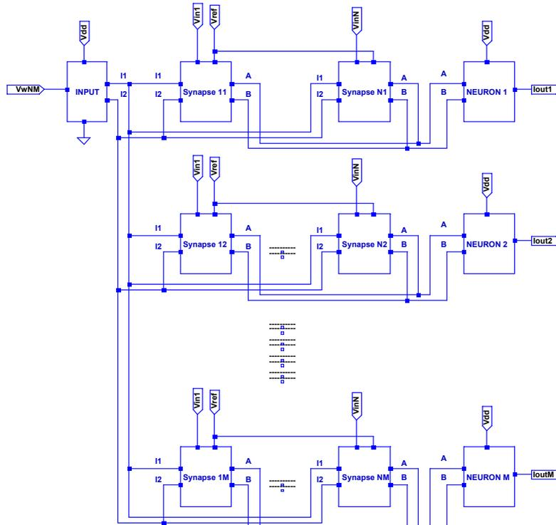
Figure 8. One layer of multi layer perceptron.
