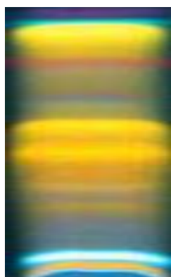
Profil chromatographique de l'extrait colorant hydro-alcoolique Annickia chlorantha observé sous UV/366 après révélation avec le réactif de Dragendorff.
