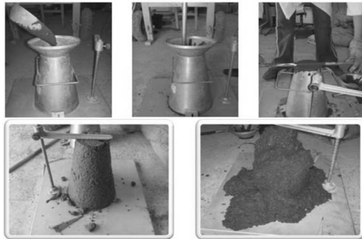
Figure 3. Test d'ouvrabilité au cône d'Abrams.
